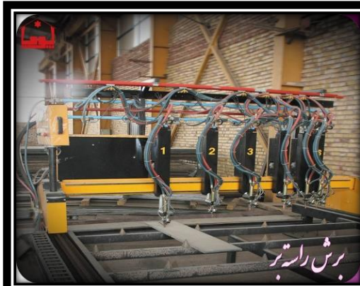
کوتین ۶ متری با قابلیت برش ورق تا ضخامت ۳۰ میلی متر
