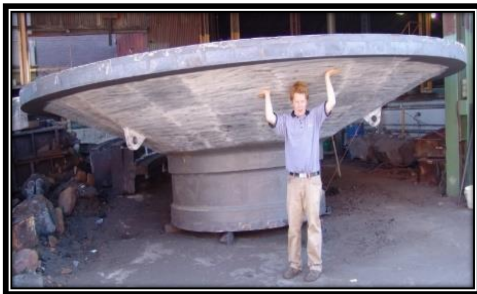
- مهندسی معکوس و ساخت دو عدد ترونیون - هدوال یک پارچه برای اولین بار برای - شرکت سیمان تهران
